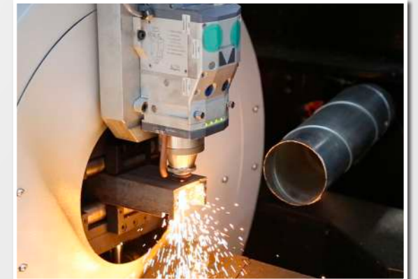
Boru ve profil kesme seçeneği, boru, kare, dikdörtgen, "U" ve "L" şeklindeki profillerin kesilmesine olanak sağlar.
