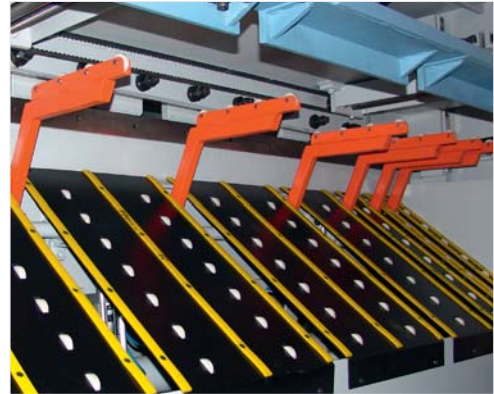
■ Kollu tip pnömatik sac destek sistemi üzerindeki tekerlekler ve bilyalar sayesinde kesilen sac en az çizilme ile kaydırılır (O)
