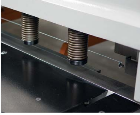
■ Gölge teli, kesilecek sac üzerinde izdüşüm oluşturarak, kaliteli ve hassas kesimler yapılmasını sağlar (S)
