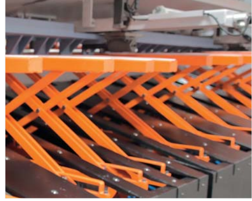
■ X tipi pnömatik sac destek sistemi yere paralel şekilde çalışarak kesilen sacı kesim süresince desteklemektedir (O)
