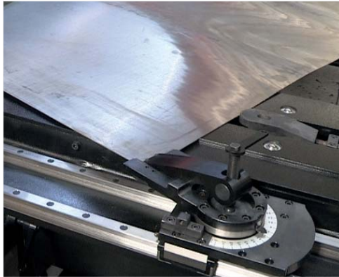
■ Açı ayarlı ön sac sürme sistemi ile sacları acılı kesmenize olanak sağlar (O)
